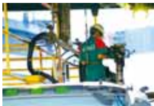
安全帯を使用しているタンクローリーへの充てん作業
