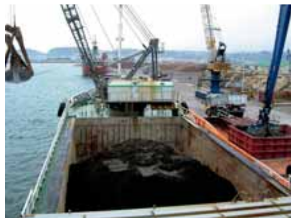
中間処理した土壌の船積み作業(セメント原料として搬出)
