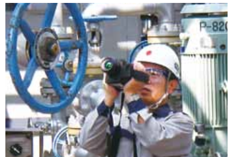
VOC発生状況調査の様子
