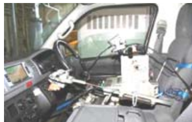
コンピューター制御により 変速操作をコントロール
