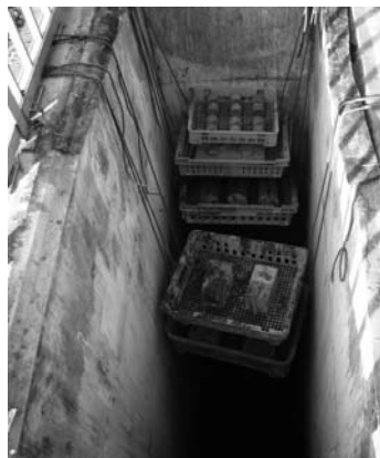
写真1 暴露試験の検体設置状況
