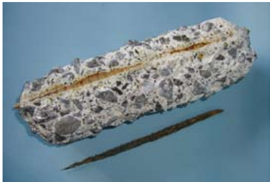
図10 鉄筋入りセメントコンクリートの暴露試験後の外観
