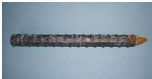
図12 セメントコンクリートの暴露試験検体から取り出した鉄筋
