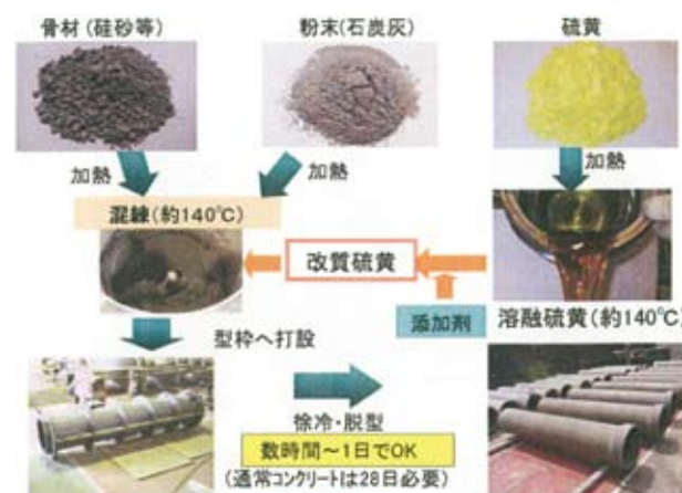
図2 レコサールの製造フロー
