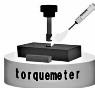
図 5 タッピング試験の概略図
