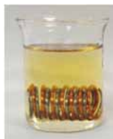
図 3 熱安定性試験後の外観 (フードマシンマルチ 32)
