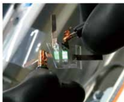
図10 CpODA系ポリアイミドを用いたフレキシブル有機EL素子
