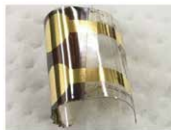
図9 CpODA系ポリアイミドを用いたフレキシブル太陽電池
