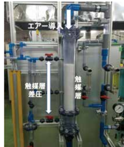
図11 触媒層の差圧測定装置の外観
