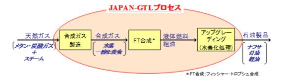
合成ガス製造: 天然ガスを合成ガス(水素と一酸化炭素)に転換
