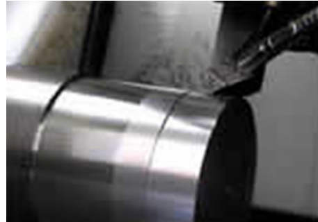
極微量の油で金属加工を行うニアドライ加工
